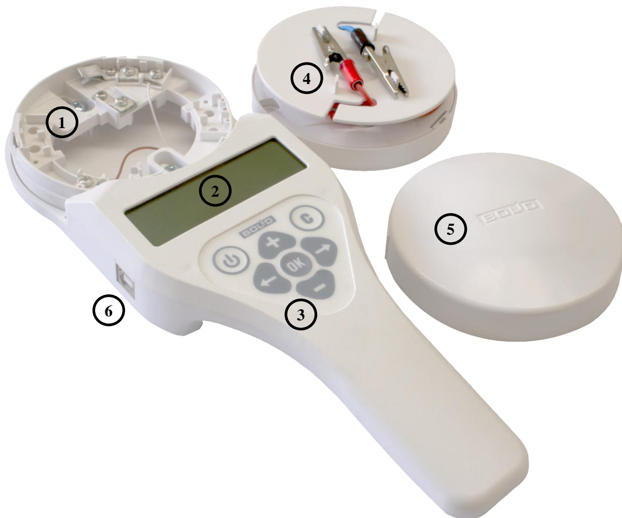
Рисунок 1. Внешний вид и органы управления программатора.
